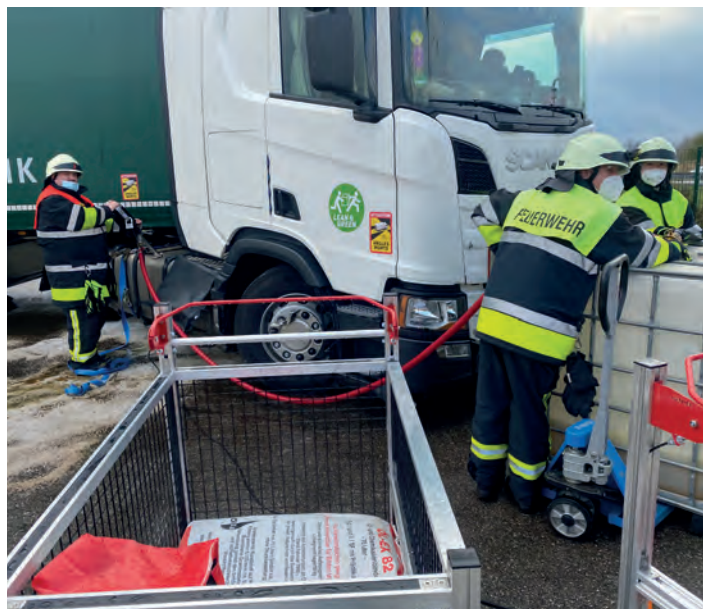
Umpumpen von Diesel
