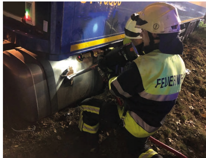
Umpumpen des Kraftstoffes
